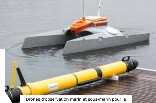
Drones d'observation marin et sous-marin pour la cartographie autonome du lac de Guerlédan.
