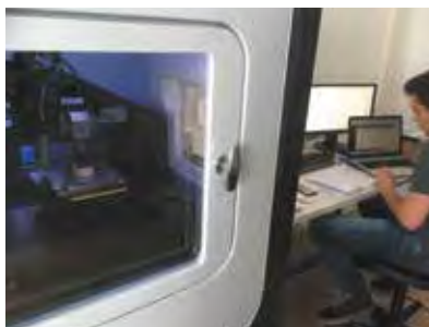
Triboindenteur pour essais mécaniques à l'échelle nanométrique (microstructure des matériaux)
