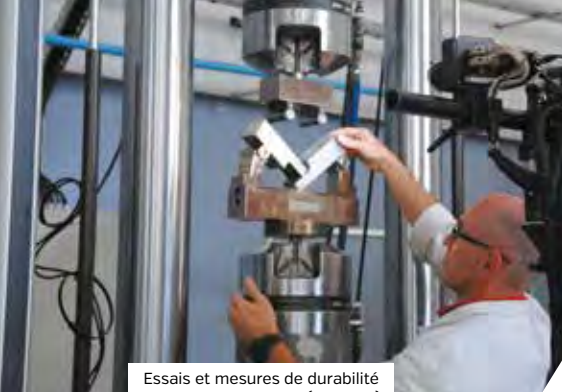
Essais et mesures de durabilité d'assemblages collés (cf. focus)
